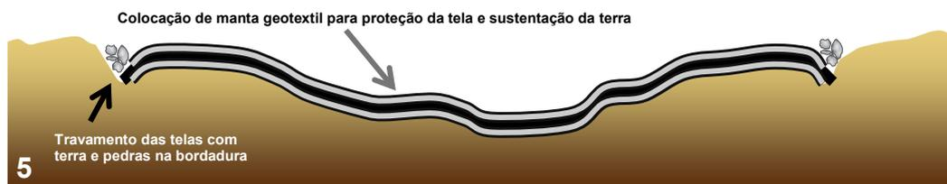
6— Por fim coloca-se terra sobre a manta geotêxtil e de seguida colocam-se pedras e mais terra para que as plantas se possam fixar e criar irregularidades no fundo e nas margens do charco. É conveniente a construção de algumas ilhas.
